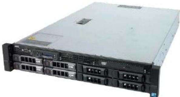
Dell PowerEdge R510 — это двухпроцессорный сервер для установки в стойку с форм-фактором 2U и расширенными возможностями управления, недорогими опциями RAID-массивов и отличным сочетанием внутренней системы хранения, возможностей резервирования и цены в компактном корпусе. Способен удовлетворить потребности малых и средних предприятий, а также крупных корпораций, обеспечивая отличную платформу для основных бизнес-приложений.
